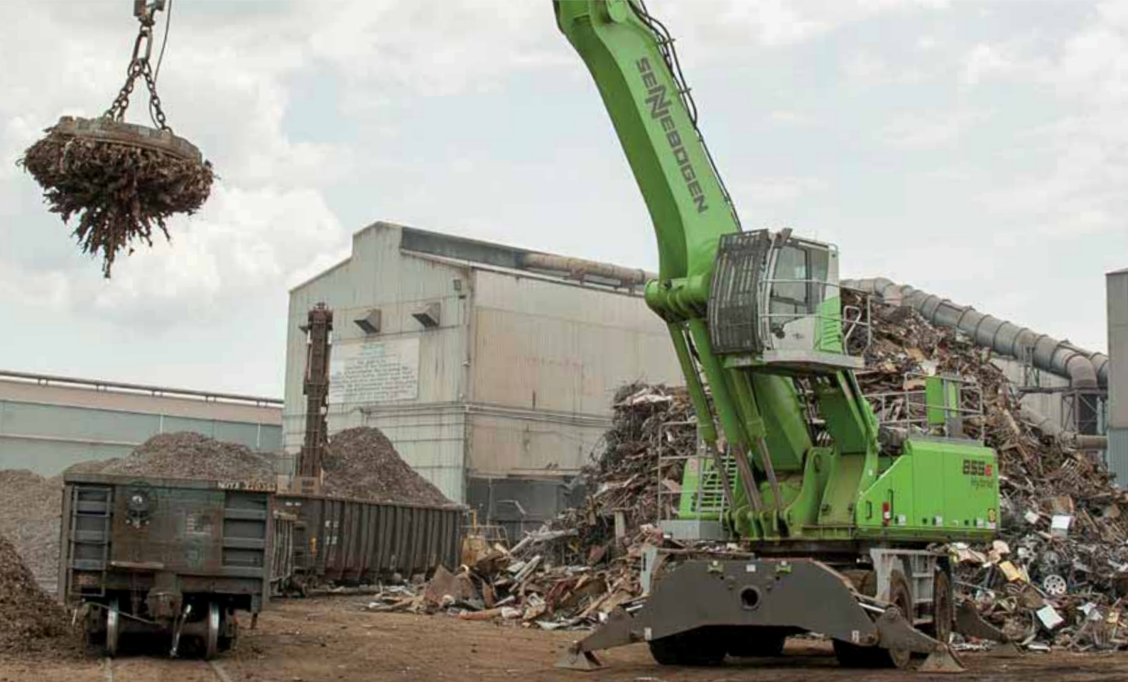
SENNEBOGEN 855 Hybrid - Schrottschlag mit Magnet SENNEBOGEN 855 Hybrid - Scrap handling with magnet
