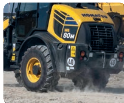
40 km/h-re korlátozott hidrosztatikus hajtáslánc (opcionális felszereltség)
