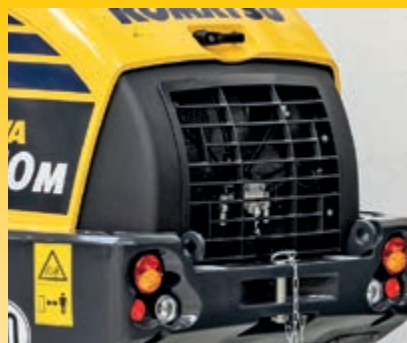
Széles hűtő (választható) megfordítható ventilátorral
