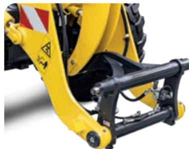
Elektromos működtetésű gyorscsatlakozó a szerelések gyors és egyszerű cseréjéhez
