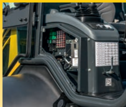
Oldalsó burkolat a karbantartási célból történő gyors hozzáféréshez
